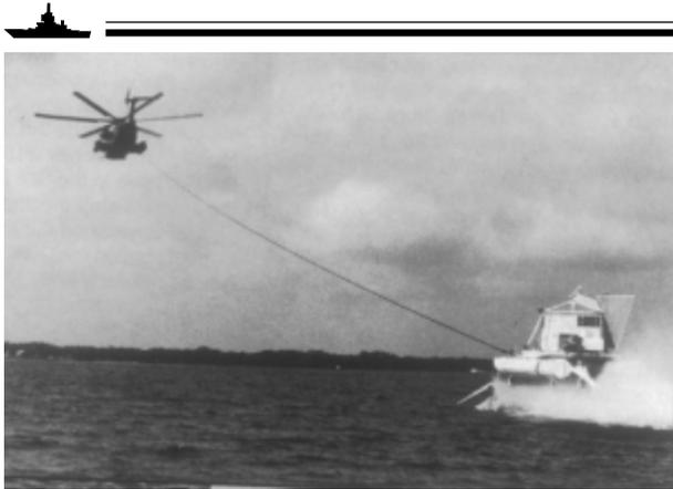
Рис. 2. Буксировка неконтактного трала Mk108
