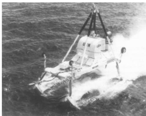
Рис. 3. Неконтактный трал AN/ALQ-166
